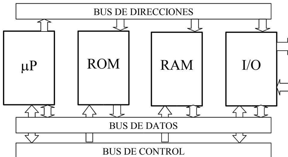
La figura anterior muestra los diferentes bloques y su estructura de conexión más común, conocida como arquitectura von Newman.
